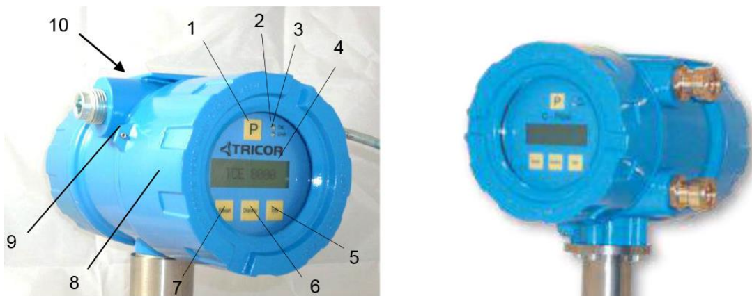
FIGURA 4: ELEMENTOS DE OPERAÇÃO DO TCE80XX-E (DIREITA), TCE80XX-W (ESQUERDA) DA VERSÃO INTEGRAL.
