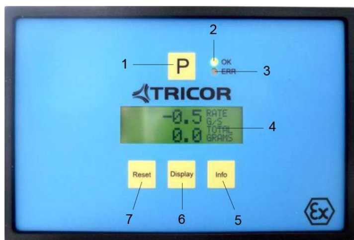
FIGURA 6: ELEMENTOS DE OPERAÇÃO DO TCE80XX-L*-Ex
