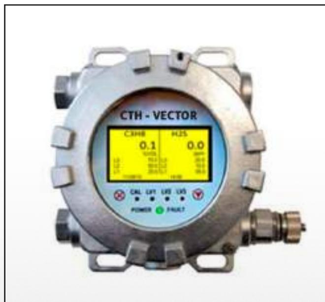
O CTH-VECTOR é uma unidade de controle de campo de última geração que funciona como um terminal de controle integrado e visor OLED, para a linha de detectores de gás da Contech. A unidade de controle de campo (FCU- Field Control Unit) CTH-VECTOR pode ser instalado remotamente até 150 metros do local de instalação de um detector de gás. O detector também pode ser ligado diretamente ao CTH-VECTOR tornando uma unidade de detector / monitor unificado.
