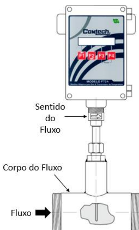
fig. 2.8: Orientação de um medidor Inline - setas direcionais
