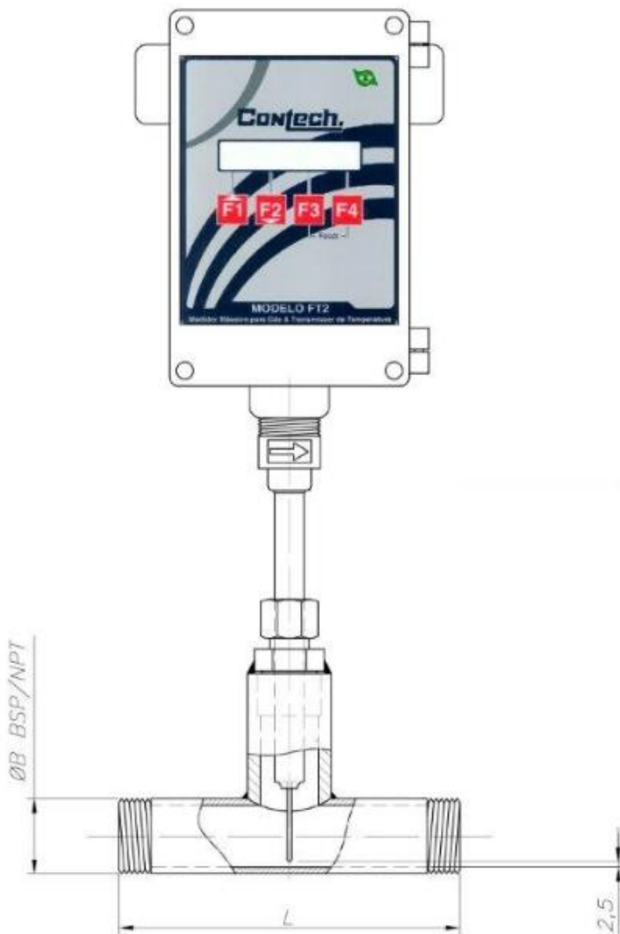
fig. 7.5a: Medidor Tipo Inline com corpo do fluxo e conexões de extremidade NPT até 1 1/2"
